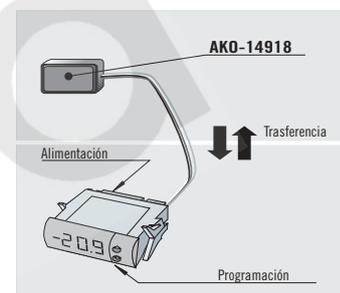
**Volcado o copia rápida de los parámetros introducidos en el servidor portátil hacia el controlador:** Mantener pulsada la tecla **▶** mientras se conecta el controlador a la alimentación hasta que el display muestre **CPY**, indicando que la transferencia ha sido correcta. Desconectar y volver al conectar el controlador de la alimentación. También se puede realizar el volcado desde el parámetro L6=2.
